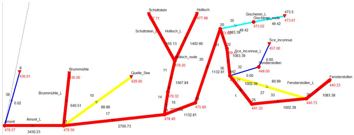
Figure 15 *Crue moyenne : Idem avec un conduit de 1 cm de diamètre. Cette situation correspond à la situation sans recoupement par la galerie de sécurité. Débit d'entrée 3430 L/s.*
